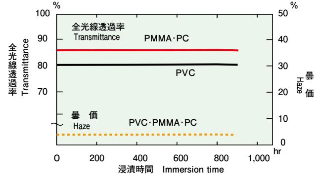
Hard Coat DC Plate (PVC・PMMA・PC)
