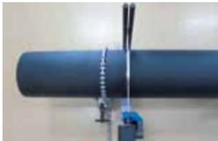
パイプカッターまたはハイパーソーで管軸に対して直角に切断します。
