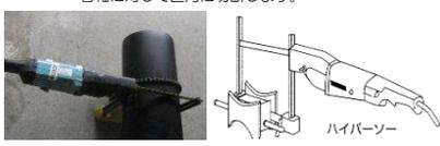
●高速砥石タイプの切断工具は使用禁止とします。
