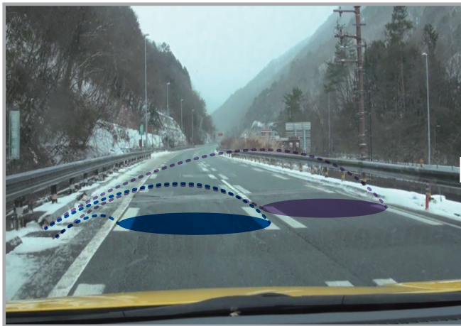
従来の散水ノズル(1車線に1ノズル)
