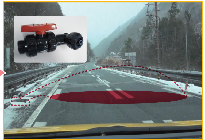
新型の散水ノズル(1ノズル2車線対応)
