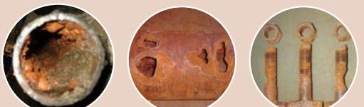
老朽铸铁管(100A) 外面マクロセル腐食 ボルト・ナットの外面腐食
